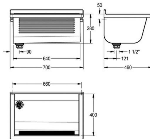
Universalwaschtrog, für Wandmontage, Chromnickelstahl, Oberfläche seidenmatt, Materialstärke 0,8 mm, mit grauem Kunststoffrahmen, 38 mm Ablaufgarnitur mit G 1 1/2 B Standrohrventil, inklusive Wandmontagewinkel, Schrauben und Dübel.
