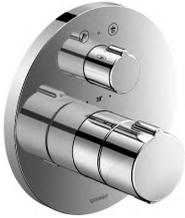
DURAVIT Thermostatischer Duschenmischer Unterputz, mit Umsteller. Linie "C1". Für 2 Verbraucher. (Handbrause + Kopfbrause). Endmontageset! Rundes Design. Ø 17 cm. In Chrom Glanz. Durchflussmenge 20.6 Lit./Min. **Notwendiges Zubehör: UP-Montagekörper BLUEBOX 1/2" oder 3/4"**. Art. No. DV\_B14210012010
