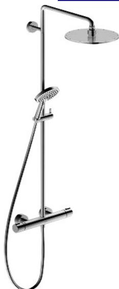
DURAVIT Thermostaten-Duschsystem Linie "C1". In Chrom Glanz. Hergestellt von KWC. Mit Kopfbrause rund  $\varnothing$  240 mm, Antikalk Duschhandbrause Air  $\varnothing$  120 mm und Design-Brauseschlauch sowie Gleiter mit Duschbrausehalterung. Ausladung unten: 100 mm. Breite 340 mm. Stichmass (Euro-Norm) 150 mm. Gesamthöhe 1200 mm. Inkl. Excenter-Raccords. Art. No. DV\_C14280 0080 10
