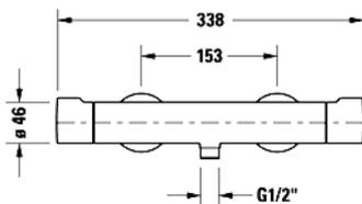
DURAVIT Thermostat Wannenmischer AP. Linie "C2". In Chrom Glanz. Hergestellt von KWC. Ausladung 196 mm. Gesamtbreite 338mm. Stichmass (CH-Norm) 153 mm. **OHNE Raccords 1/2" und OHNE Rosetten**. Art. No. DV\_C15220 000S 10
