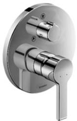
DURAVIT UP Duschenmischer mit Umsteller. Linie "B2". Für 2 Verbraucher. (Handbrause + Kopfbrause). Endmontageset! Rundes Design. Ø 17 cm. In Chrom Glanz. Durchflussmenge 22.5 Lit./Min. **Notwendiges Zubehör: UP-Montagekörper BLUEBOX 1/2" oder 3/4"**. Art. No. DV\_B24210 0120 10
