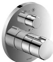
DURAVIT UP-Wannenmischer Thermostat mit Umsteller. Linie "C1". Für 2 Verbraucher. (Handbrause + Wanneneinlauf über Wanneneinlauf). Endmontageset! **Inkl. Sicherungskombination.** Rundes Design. Ø 17 cm. In Chrom Glanz. Durchflussmenge 20.6 Lit./Min. Notwendiges Zubehör: **UP-Montagkörper BLUEBOX 1/2" oder 3/4"**. Art. No. DV\_C15200 0180 10
