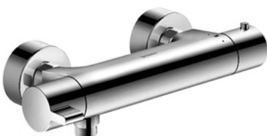
DURAVIT AP Duschenthermostat Linie B2. In Chrom Glanz. Hergestellt von KWC. Breite 260 mm Ausladung 36mm. Stichmass (CH-Norm) 153 mm. Inkl. Rückflussverhinderer im Schlauchanschluss. **OHNE Raccords und OHNE Rosetten. (Zusätzlich bestellen; No. T53814. 8 )**. Art. No. DV\_B14220 000S 10
