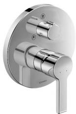
DURAVIT UP Wannenmischer mit Umsteller. Linie "B2". Für 2 Verbraucher. (Handbrause + Wanneneinlauf über Wanneneinlauf). Endmontageset! **Inkl. Sicherungskombination**. Rundes Design. Ø 17 cm. In Chrom Glanz. Durchflussmenge 22.5 Lit./Min. Notwendiges Zubehör: **UP-Montagekörper BLUEBOX 1/2" oder 3/4"**. Art. No. DV\_B25210 0180 10
