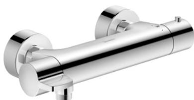
DURAVIT AP Duschenthermostat Linie B1. In Chrom Glanz. Hergestellt von KWC. Breite 200 mm Ausladung 84 mm. Stichmass (CH-Norm) 153 mm. Inkl. Rückflussverhinderer im Schlauchanschluss. **OHNE Raccords und OHNE Rosetten. (Zusätzlich bestellen; No. T53814.8)**. Art. No. DV\_B14220000S10
