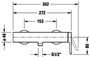
DURAVIT AP Einhand Wannenmischer im Set. Inkl. Handbrause, Design-Brauseschlauch L=160 cm und Wandhalterung! Linie "C2". In Chrom Glanz. Hergestellt von KWC. Ausladung 196 mm. Gesamtbreite 314 mm. Stichmass (CH-Norm) 153 mm. **Ohne Raccords 1/2" und Rosetten**. Der Umsteller ist rechts. Art. No. DV\_C15300 000S 10
