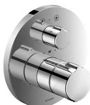
DURAVIT UP-Wannenmischer Thermostat mit Umsteller. Linie "C1". Für 2 Verbraucher. (Handbrause + Wanneneinlauf über Wanneneinlauf). Endmontageset! **Inkl. Sicherungskombination**. Rundes Design. Ø 17 cm. In Chrom Glanz. Durchflussmenge 20.6 Lit./Min. Notwendiges Zubehör: **UP-Montagekörper BLUEBOX 1/2" oder 3/4"**. Art. No. DV\_C15200 0180 10
