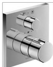
DURAVIT UP Wannenthermostat mit Umsteller. Linie "C1". Für 2 Verbraucher. (Handbrause + Wanneneinlauf über Wanneneinlauf). Endmontageset! Inkl. Sicherungskombination. Eckiges Design Platte 15x15 cm. In Chrom Glanz. Durchflussmenge 20.6 Lit./Min. **Notwendiges Zubehör: UP-Montagekörper BLUEBOX 1/2" oder 3/4"**. Art. No. DV\_C15200 0170 10
