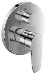
DURAVIT UP-Wannenmischer mit Umsteller. Linie "B1". Für 2 Verbraucher. (Handbrause + Wanneneinlauf über Wanneneinlauf). Endmontageset! **Inkl. Sicherungskombination.** Rundes Design. Ø 17 cm. In Chrom Glanz. Durchflussmenge 22.5 Lit./Min. Notwendiges Zubehör: **UP-Montagkörper BLUEBOX 1/2" oder 3/4"**. Art. No. DV\_B15210 0180 10
