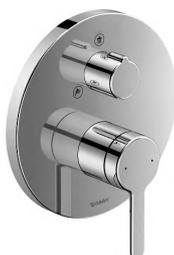
DURAVIT UP Duschenmischer mit Umsteller. Linie "C1". Für 2 Verbraucher. (Handbrause + Kopfbrause). Endmontageset! Rundes Design.  $\varnothing$  17 cm. In Chrom Glanz. Durchflussmenge 22.5 Lit./Min. **Notwendiges Zubehör:** UP-Montagekörper BLUEBOX 1/2" oder 3/4". Art. No. DV\_C14210 0120 10
