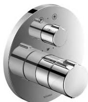
DURAVIT UP-Wannen-Thermostat mit Umsteller. Linie "C1". Für 2 Verbraucher. (Handbrause + Wanneneinlauf über Wanneneinlauf). Endmontageset! **Inkl. Sicherungskombination**. Rundes Design. Ø 17 cm. In Chrom Glanz. Durchflussmenge 20.6 Lit./Min. Notwendiges Zubehör: **UP-Montagekörper BLUEBOX 1/2" oder 3/4"**. Art. No. DV\_C15200 0180 10
